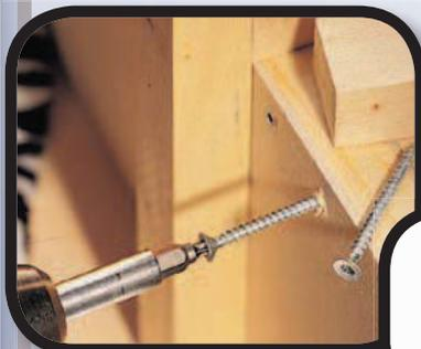
Dans les matériaux tendres (bois) l'effort nécessaire augmente régulièrement pendant le vissage. Une pression est donc exercée en permanence, très forte en fin de vissage. Plus l'acier de l'embout sera «dur» moins il s'usera.
