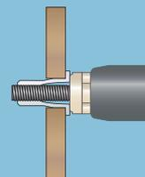
5. Placer l'écrou aveugle dans le perçage des pièces à assembler jusqu'au contact de l'enclume.
