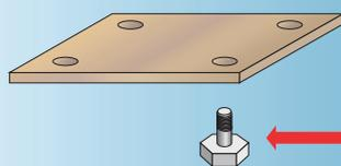
1. Choisir la tige filetée et l'enclume correspondant au diamètre du pas de vis du futur boulon à visser.
