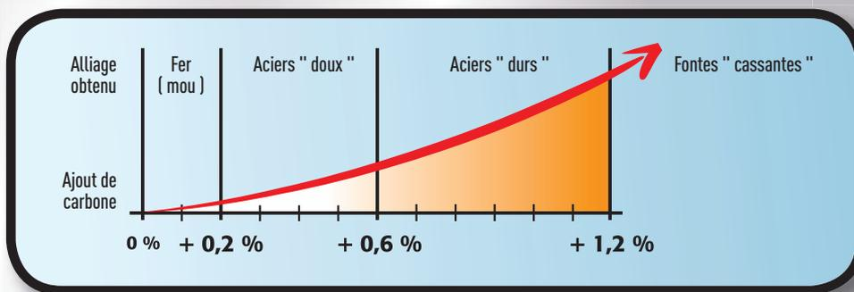
Le carbone durcit le fer, augmente sa résistance à la traction et diminue son élasticité. Mais dans le même temps, il diminue sa résistance aux chocs et la rend cassante.
