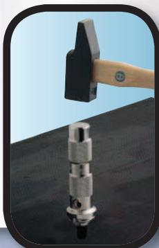
La découpe de joints pleins de diamètres inférieurs à 10 mm peut se faire en montant directement le découpe-joints sur la poignée du mandrin à plateau ou sur un mandrin monobloc.
